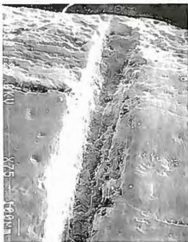
Foto de MEB a 150 x. Extremo superior del surco en el objeto 18 de la colección experimental. En él se aprecia una forma redondeada ( y, en otros casos, apuntada) en la que todos los extremos estriados se encuentran próximos y terminan en una forma compacta.
